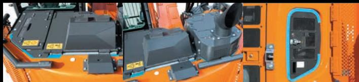
写真では隙間シールの箇所を青色で表示していますが、実物の色とは異なります。
