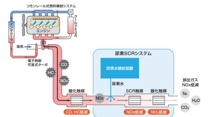
**尿素 SCR システム**: 「尿素 SCR システム」は NOx を浄化する後処理技術です。エンジンの排出ガスは、連結パイプ内で噴射された尿素水 (アンモニア) と混合し、SCR 触媒および DOC (ディーゼル酸化触媒) によって無害な水と窒素に分解。排出ガスのクリーン化に貢献します。
