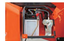
レバーを動かすだけで、簡単かつ安全にバッテリーを遮断。メンテナンス中の感電事故を防止するとともに、長期不使用時に遮断することでバッテリーの消耗を低減します。
