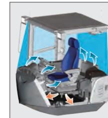
温度設定によって、風量や吹き出し口、温度を自動的にコントロール。さらに、足元を暖かく、顔部分を冷やすといったように、場所によって温度を変えることができるバイレベル機能を搭載。また、キャブ内の気圧を外部よりわずかに高めた加圧キャブは碎石現場などで発生する非常に細かい粉じんの侵入を防ぎ、キャブ内を清潔に保ちます。また、ほこりの多い現場向けに、エアコン外気ダブルフィルタをオプションで用意しています。
