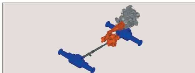
積荷走行が多い欧州の現場で実証された、信頼性・耐久性が高いトランスミッションを採用しました。アクスルは、ハウジング形状の最適化や最適部材などで過酷な路面環境に耐えられる信頼性を実現しています。
