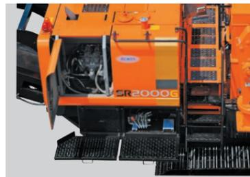
油圧ポンプなどのメンテナンス用にサイドステップを装備しました。フィルタ交換などの各種点検、整備作業を容易にします。
