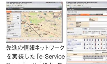
先進の情報ネットワークを実装した「e-Service Owner's site」によって、機械の予防保守管理は、電子情報へと変革します。私たち日立建機は、機械情報をお客様と共有することで、定期点検時期やオイル交換時期の判断要素とします。また、万が一機械に異常が発生した場合でも、警告情報から原因を診断し、位置情報により機械の場所を地図上で確認できます。お客様の休車時間を低減し、迅速で的確なサービスを目指しております。
