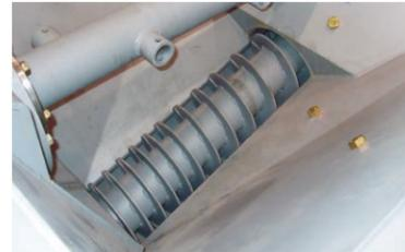
シュート形状の変更、スクリューフィーダの大径化により固化材の排出性を向上しました。
