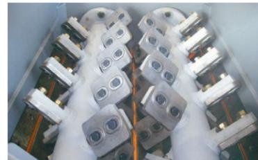
混合機には「2軸パドルミキサ」方式を採用し、さまざまな性状の原料土に対応します。
