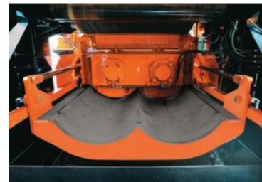
混合機ラインには耐衝撃性に優れた材質を採用。耐久性を向上するとともに、下部ケーシングは油圧シリンダにより開閉可能として点検、清掃を容易にしました。
