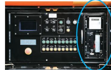
処理土量、固化材量を作業時間ごと、もしくは作業日ごとで出力するためのプリンタを標準装備しました。
