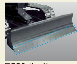
BOCブレード (Bolt-On Cutting edge 付き)
