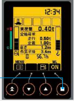
過負荷警報装置(マルチモニタに内蔵)
