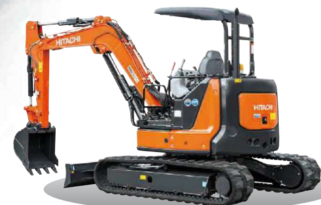
ZAXIS 50U (2柱キャノピ、アタッチメント配管仕様)
