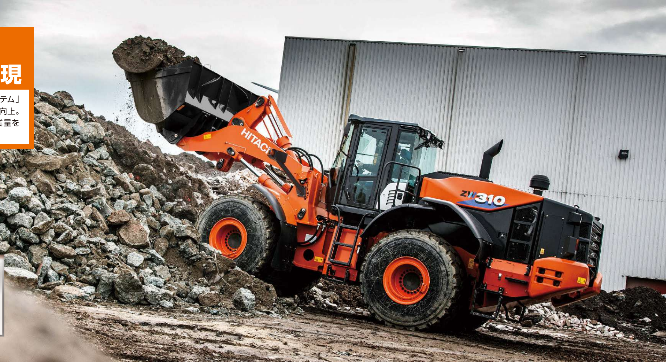
写真はオプションのラジアルタイヤ、フルフェンダ（マッドフラップ付き）、ブレイクリーナ（サイクロン式）、後方作業灯、バケットシリンダロッドガードを装備しています。
