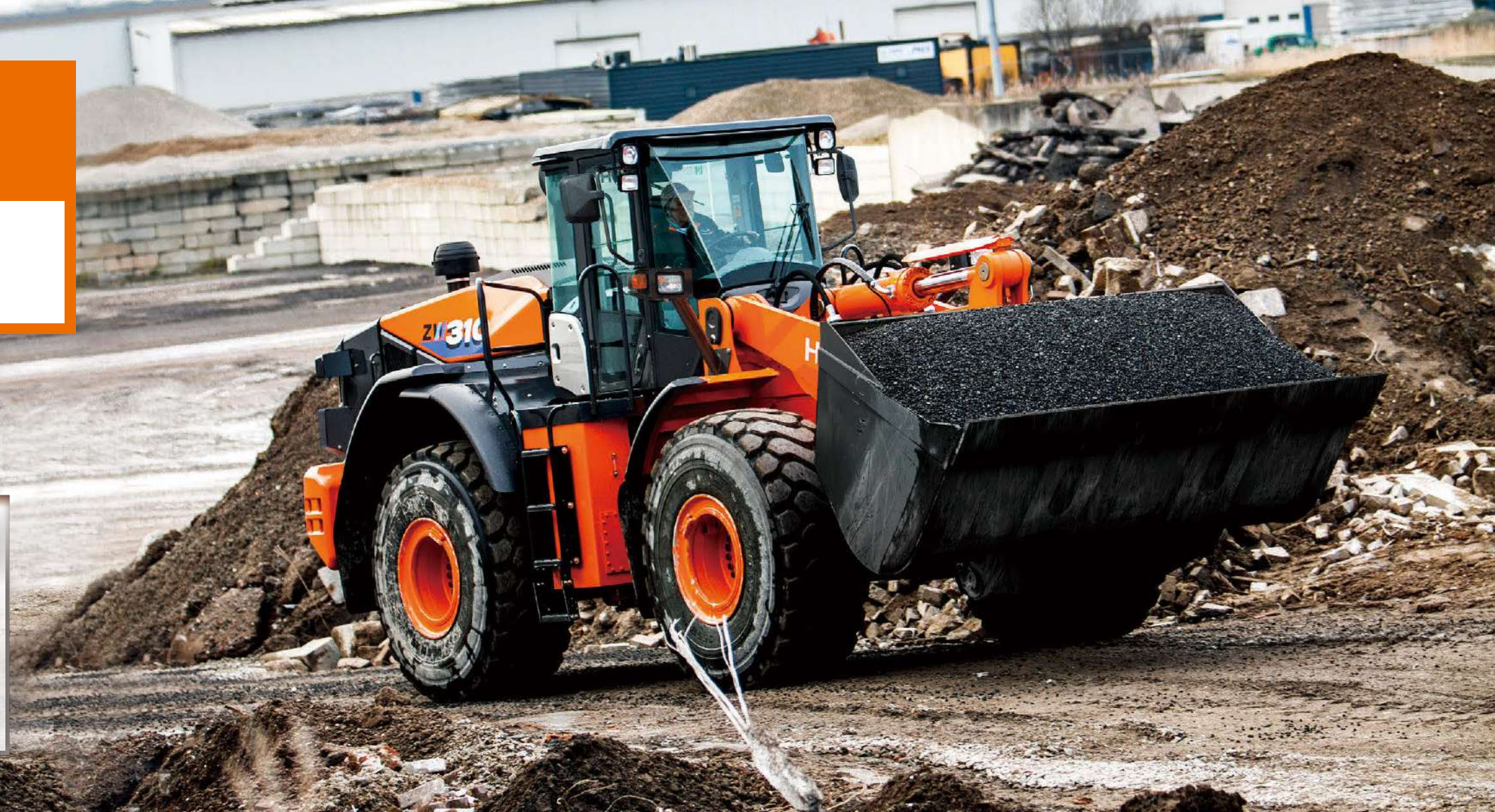
写真はオプションのラジアルタイヤ、フルフェンダ（マッドフラップ付き）、ブレイクリーナ（サイクロン式）、追加前方作業灯、バケットシリンダロッドガードを装備しています。
