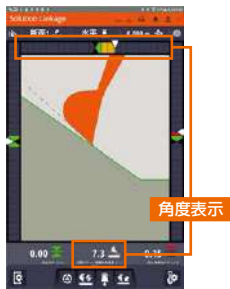
目標面に対する バケット角度表示例
