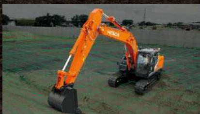
位置情報により掘削面を認識
