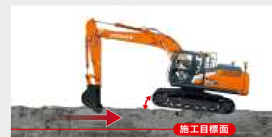
掘削力制御説明図
