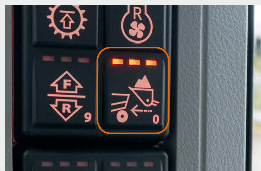
アプローチスピードコントロールの 制限速度のインジケータ表示 3段階(弱 9 km/h / 中 8 km/h / 強 7 km/h)
