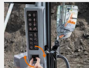
電動調整機能付きバックミラーと調整ノブ
