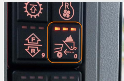
アプローチスピードコントロールの制限速度のインジケータ表示
