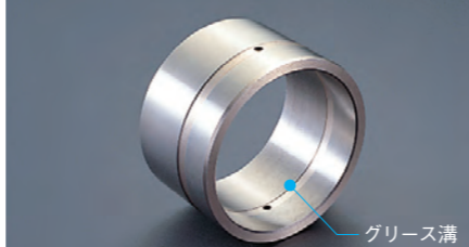
作業機ジョイント部に潤滑特性に優れたHNブッシュを採用し給脂間隔を250時間としました。<注>稼働開始から50時間までの給脂間隔は取扱説明書に従ってください。
