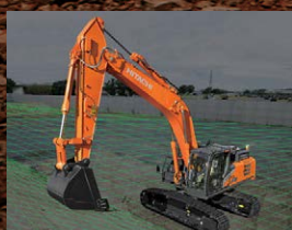
位置情報により掘削面を認識
