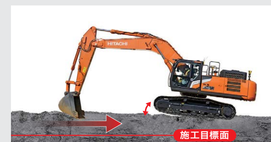
掘削力制御説明図
