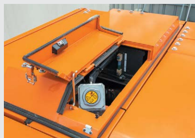
エキスパンションタンク
