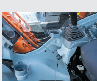
コンソール前方ドリンクホルダ NEW エアコン送風機能付きドリンクホルダ
