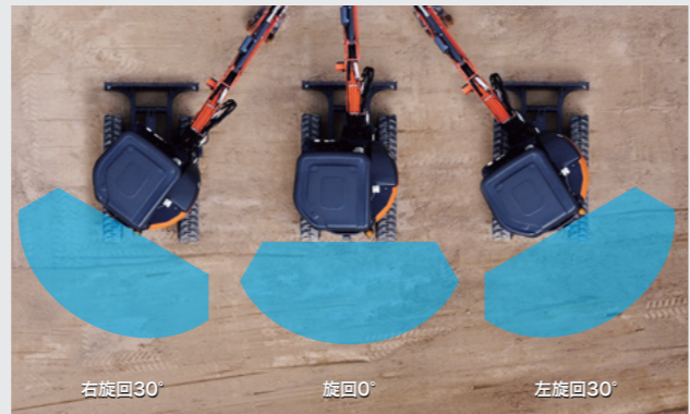
整地作業における、旋回位置による検索範囲のイメージ図
