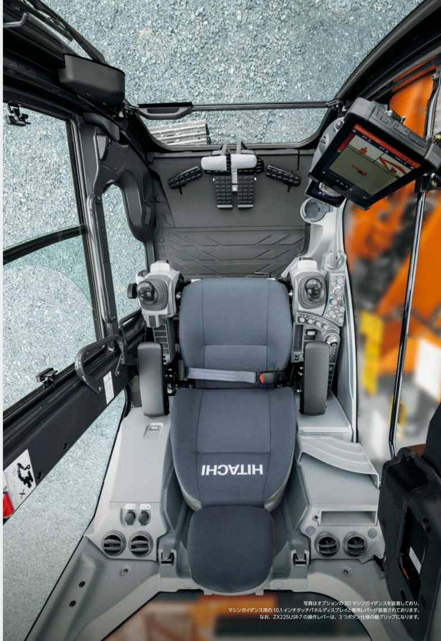
写真はオプションの3Dマシンガイダンスを装着しており、マシンガイダンス用の10.1インチタッチパネルディスプレイと専用レバーが装着されております。なお、ZX225USR-7の操作レバーは、3つボタン仕様の細グリップになります。
