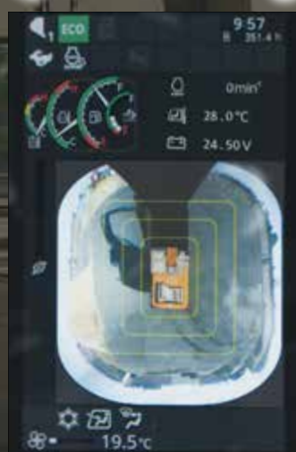
AERIAL ANGLE® 全周囲表示例
