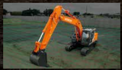
位置情報により掘削面を認識
