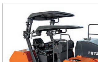
ガススプリングでキャノピ折りたたみ作業をサポート
