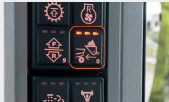
アプローチスピードコントロールの制限速度のインジケータ表示 3段階(弱 9 km/h / 中 8 km/h / 強 7 km/h)
