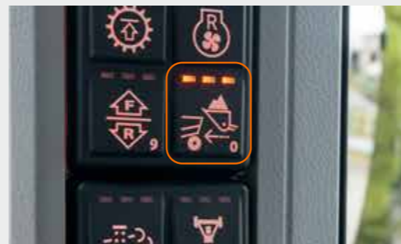
アプローチスピードコントロールの制限速度のインジケータ表示 3段階(弱 11 km/h / 中 10 km/h / 強 9 km/h)
