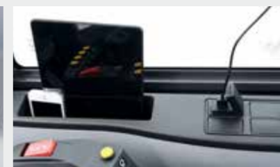
スマートフォン&タブレットホルダとUSB充電ポート NEW
