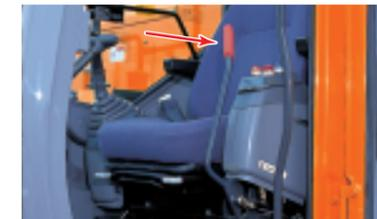
油圧ショベル感覚で安全を確保できるよう、ロックレバーを標準装備。ロックレバーを上げると走行・旋回・ダンプ操作をロックします。
