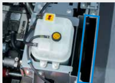
ラジエータ清掃窓
