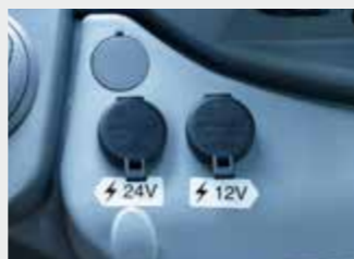
24V電源と 12V電源 NEW
