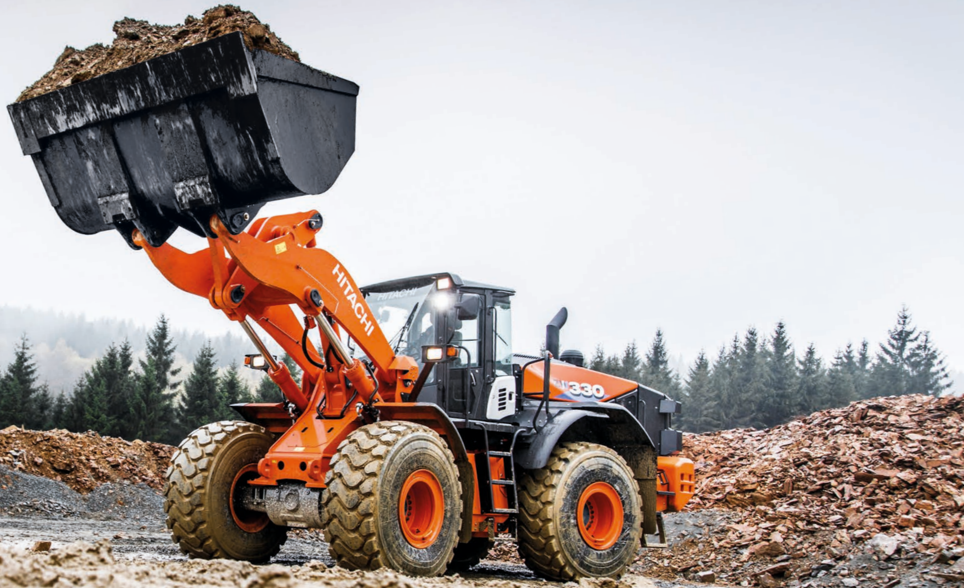
※写真は、オプションのプレクリーナ(サイクロン式)、前方作業灯(キャブ用、2灯、LED)、フルフェンダ(マッドフラップ付き)を装備しています。
