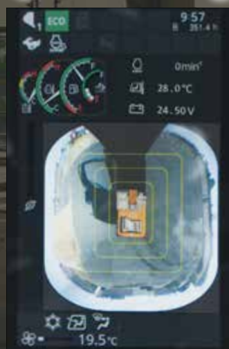
AERIAL ANGLE® 全周囲表示例
