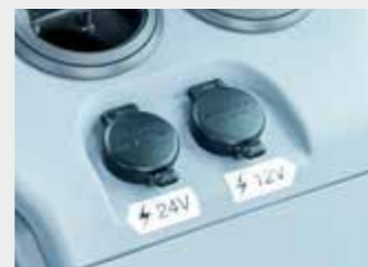
24V電源と 12V電源 NEW
