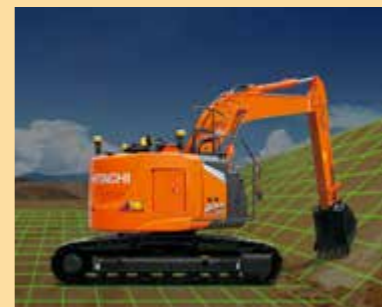
位置情報により掘削面を認識。
