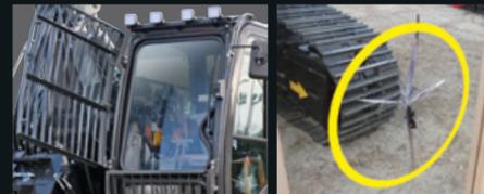
運転席の前窓にポリカーボネートを採用、万一作業中にチェーンが折損・飛散した場合の安全性を高めています。また安全性確保のため前窓は開閉しません。
