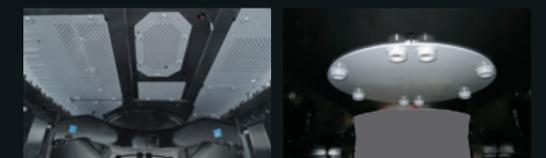
上部旋回体に強化型旋回体アングカバーを、下部走行体には高張力鋼製強化型トラックアングカバーを装備しました。※画像の本体は別機種です。
