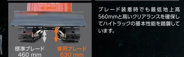
ブレード装着時でも最低地上高560mmと高いクリアランスを確保してハイトラックの基本性能を踏襲しています。
