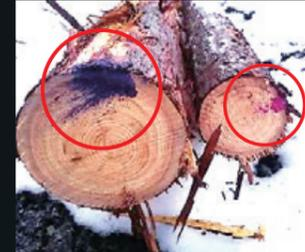
赤・青2本のスプレーで、同じ長さを4種類に色分け、製品の品質や仕向け先別に仕分け作業を効率化。
