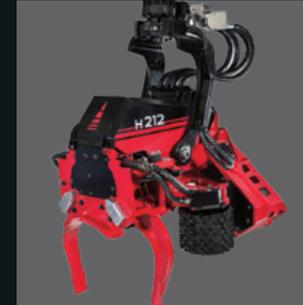
フロントナイフの最大開口幅500mm。開口時のヘッド幅を短縮し、間伐処理での作業性を向上。
