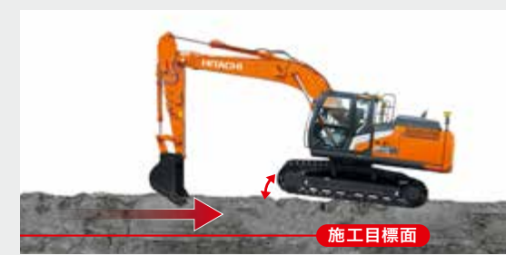
掘削力制御説明図
