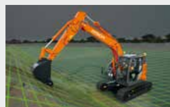
位置情報により掘削面を認識
