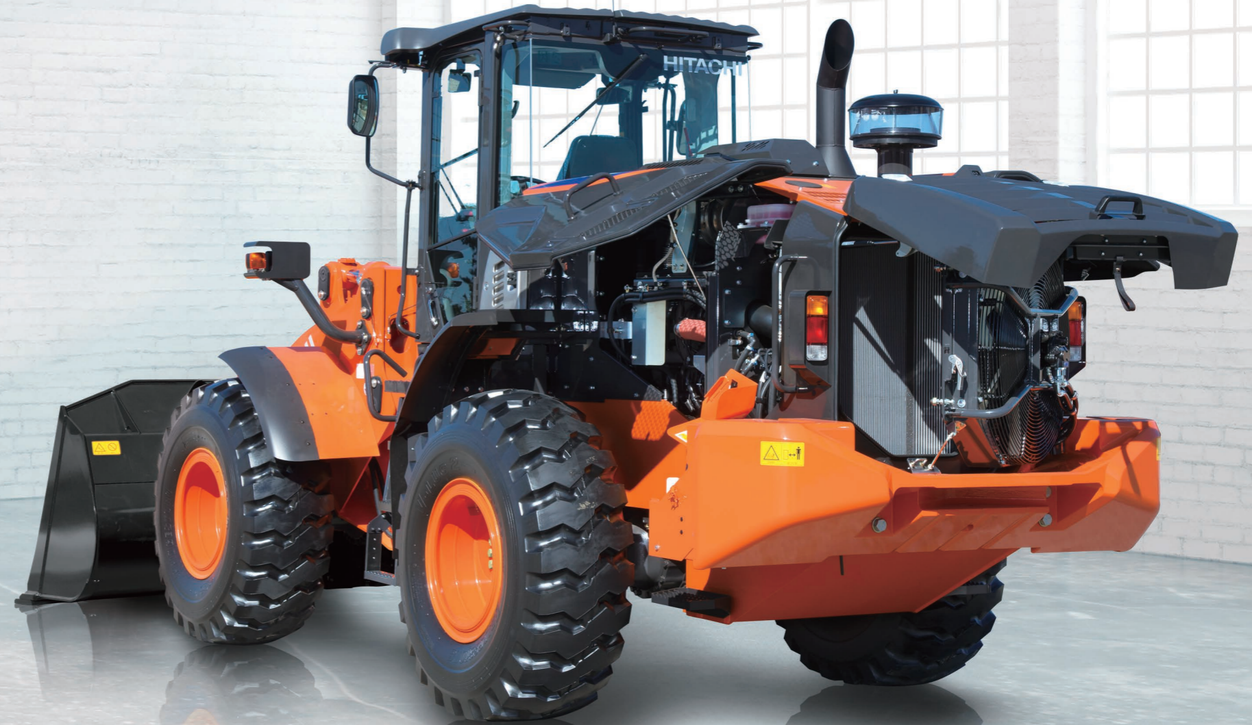
写真はオプションのプレクリーナ (ボウルタイプ)を装備しています。
