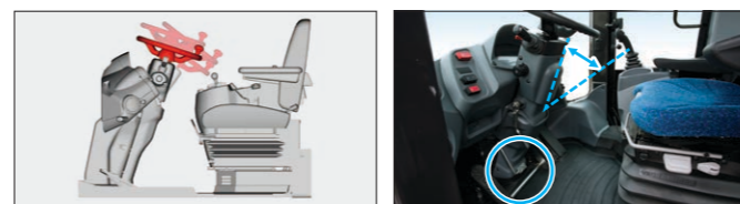
チルト&テレスコピック機能付きステアリングホイール ポップアップステアリングコラムとペダル
