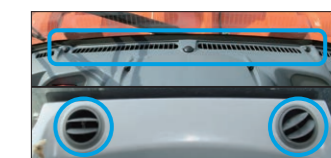
エアコン吹き出し口&デフロスタ
