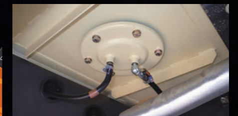
内部を清掃しやすくなった燃料タンク
