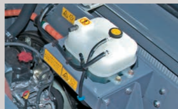
エキスパンションタンク
