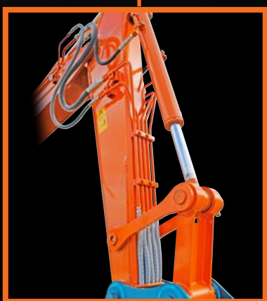
アーム上面に配管を集約 ホースの破損を軽減
