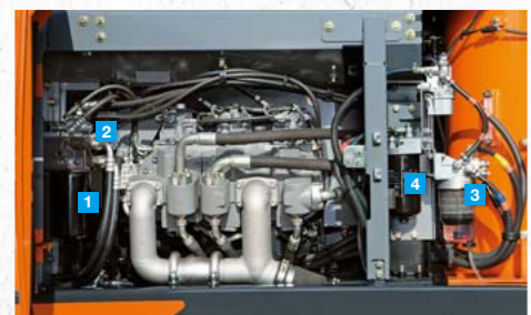
1 エンジンオイルフィルタ 2 パイロットフィルタ 3 燃料プレフィルタ 4 燃料メインフィルタ
