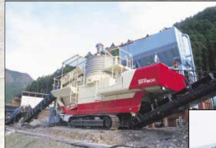
SR-P特殊仕様機：SR-P1200をベースに混合機容量を拡大させた仕様。処理能力は向上しますが、適応土質に限られます。
