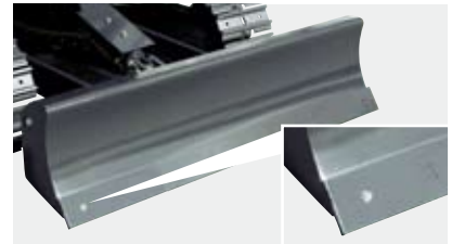
BOC(Bolt-On Cutting edge) 付きブレード
