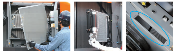
防塵ネット 開閉式エアコンコンデンサ ラジエータ清掃窓
