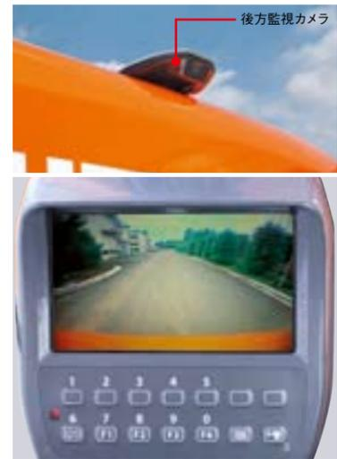
カウンタウイト部に後方監視カメラを搭載。キャブ内のモニタで後方を確認でき、後進時の確認に役立ちます。
