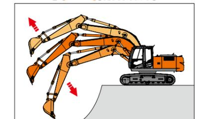
ブーム下げ時のフロントの重さを利用して、圧油をブーム回路内で循環（再生）する機構。この結果、ポンプからの圧油を集約的にアームに供給することができ、アーム/ブーム下げ複合操作時のアーム動作のスピードアップが大幅に図られました。
