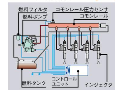
排出ガス3次規制に対応するため採用した新しいタイプの燃料噴射システムです。燃料ポンプを超高圧で駆動し、気筒ごとのインジェクタに燃料を分配して噴射するシステムです。さらに、電子制御により1,000分の1秒単位で燃料の噴射タイミング、噴射量をきめ細かに制御。この結果、燃料噴射量の最適化が図れ、高出力化ならびに不完全燃焼によるPM(黒煙などの粒子状物質)の低減や低燃費を実現します。
