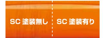
SC塗装は、親水性の塗料の自浄作用により、雨水と埃(ほこり)と一緒に流れてしまいます。雨だれ跡がつきにくく、付いても落としやすい塗装です。
