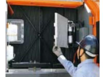
エアコンコンデンサを開閉式にすることで、エアコンコンデンサやその裏側に配置されたラジエータなどの清掃を簡素化しました。
