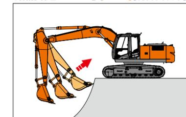
今まで、タンクに戻っていたブーム戻りの圧油をアーム動作に再利用しました。この機構により、掘削時のアーム引き動作のスピードアップが大幅に図られました。
