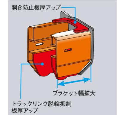
アイドラブラケット開き防止板厚およびトラックリンク脱輪抑制板厚を増加。外方向への開きを防止し、トラックリンクおよびローラ類などの足回り部品の耐久性が向上しました。
