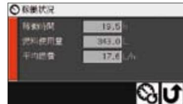
前回行った給油時からの稼働時間、燃料使用量、平均燃費をモニタに表示します。
