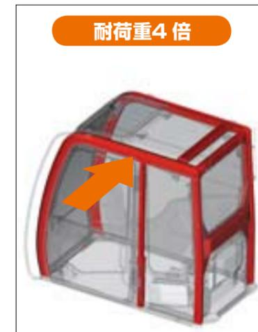
キャブの強度、剛性が大幅にアップした転倒時運転者保護構造を採用し、転倒に対する安全性を向上。この構造は、日本のJCMASが規定する安全基準（EOPS）に適合し、さらにISOで規格化の方向で審議中です。例えば、キャブ上部に横方向の荷重を加えた場合、従来機ZAXISに比べ4倍の荷重に耐えることができます。
