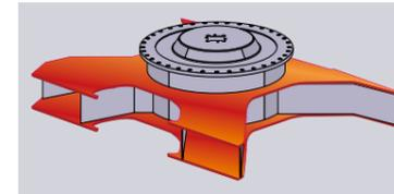
Xビーム構造のボックス寸法拡大や構造改良により、断面性能が最大で35%向上(対従来機ZAXIS)。さらに、上下板には1枚板の曲げ構造を採用しました。溶接部を減らすことで、Xビーム構造の強度および品質が向上しました。
