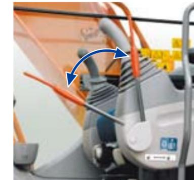
ロックレバーが完全にロックしていないとエンジンが始動できないニュートラルエンジンスタート機構を採用。レバーに触れていることに気づかずエンジンを始動して、急に機械が動いてしまうことを防ぎます。
