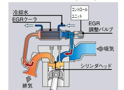
一度燃焼させた排出ガスの一部を吸入空気と混合し、再燃焼させる機構です。燃焼室内の酸素濃度を抑制することとEGRクーラにより燃焼温度を下げることで、高出力を確保しつつ大気汚染物質であるNOx(窒素酸化物)の排出低減と低燃費を実現します。
