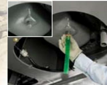
エンジンオイルパンにドレンカバーを装備。備え付けのノズルホースにより、容易にドレン作業が行えます。
