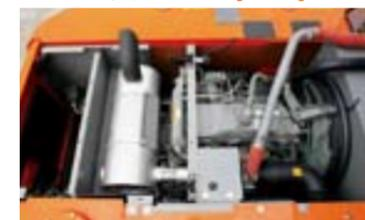
■ **140 kW (190 PS) / 2,100 min<sup>-1</sup> (rpm)**
