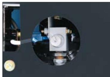
エンジンオイルパンにドレンカブラを装備。備え付けのノズルホースにより、容易にドレン作業が行えます。
