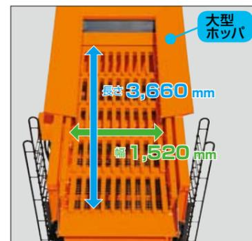
1,520 mm 幅スクリーンと大型ホッパ (2,360 × 2,950 mm) の採用により、油圧ショベルからの直接投入が容易に行えます。さらに、材料の高精度な選別を実現するために、材料移動方向の長さを 3,660 mm としたスクリーンボックスの配置を採用しました。
