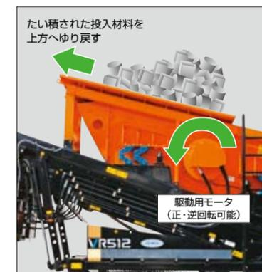
スクリーン逆転機能により材料の滞留時間を延ばし、高精度の選別を可能にしました。4段階のスクリーン角度との組合せで、より幅広い作業内容に対応できます。
