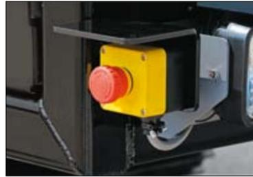
緊急時にエンジンを停止させる非常停止装置を5カ所装備しています。
