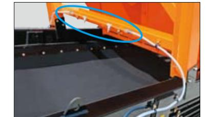
アンダコンベヤ部に上水道利用の散水ノズルを2カ所装備、粉塵の発生を低減します。
