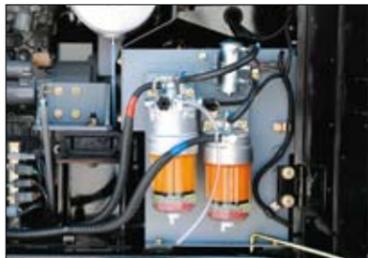
高性能燃料フィルタを装備し、エンジン燃料系統の目詰まりなどによる故障を低減します。
