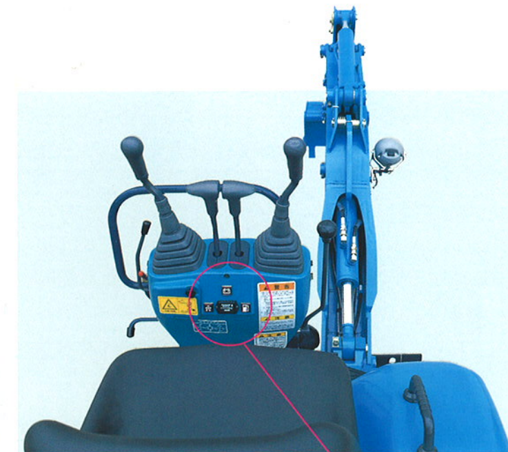
前方視界に優れた運転席 ブーム取り付け部を右よりにオフセットし、 作業時のバケットを見やすくしました。
