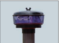
ブレックリーナ (ボウル式) 吸気力で渦を発生させ、大きなゴミを分離するブレックリーナです。ダストカップの定期的な清掃が必要です。
