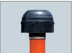
ブレックリーナ (サイクロン式) 吸気力で渦を発生させ、大きなゴミを分離するブレックリーナです。内部にある羽根によって、捕集したダストを自動排出します。
