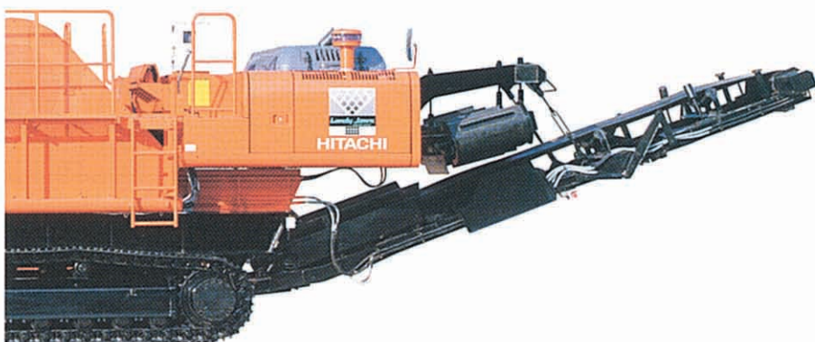
折り畳み式メインベルトコンベヤ
