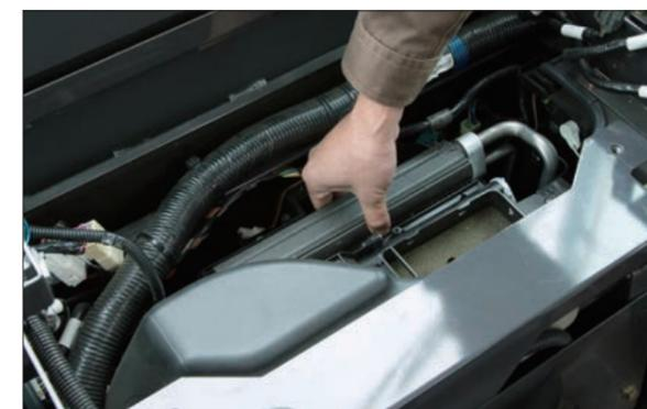
内外気フィルタの集じん効率を上げ、エアコンユニットに侵入する粉じんを大幅に低減しました。さらにエバポレータの材質を見直すことで、耐食性を2倍に向上。万一、エバポレータの交換が必要な場合でも、シート後ろのカバーを外すことで容易に交換できます。
