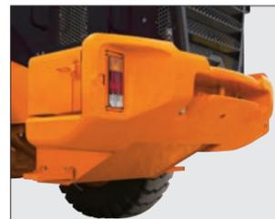
地面をこするほどのかき上げ作業でも、大型のカウンタウエイトで燃料タンクを保護します。
