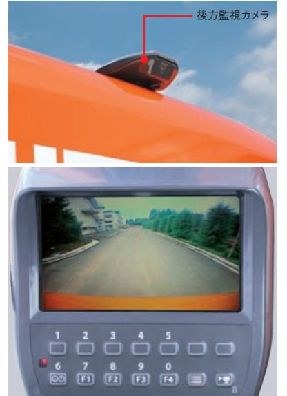
カウンタウエイト部に後方監視カメラを搭載。キャブ内のモニタに後方の映像を表示できます。
