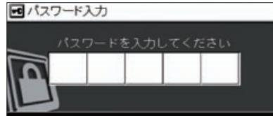
エンジン始動時に、3～5桁の暗証番号を正しく入力しないと始動しないテンキーロックシステムを採用。車両の盗難やいたずらなどを予防します。
