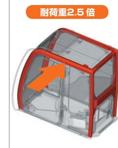
キャブの強度、剛性が大幅にアップした転倒時運転者保護構造を採用し、転倒に対する安全性を向上。この構造は、日本のJCMASが規定する安全基準(EOPS)に適合しています。例えば、キャブ上端部に横方向の荷重を加えた場合、従来機ZAXISに比べ2.5倍の荷重に耐えることができます。
