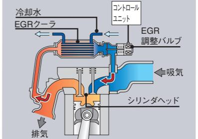
一度燃焼させた排出ガスの一部を吸入空気と混合し、再燃焼させる機構です。燃焼室内的酸素濃度を抑制することとEGRクーラにより燃焼温度を下げることで、高出力を確保しつつ大気汚染物質であるNOx(窒素酸化物)の排出低減と低燃費を実現します。
