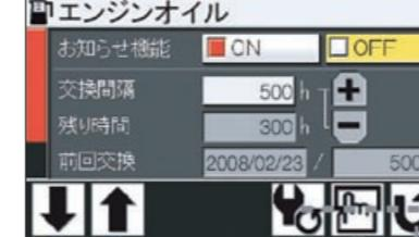
作動油や燃料フィルタの交換間隔を設定し、交換時期になるとモニタにメッセージを表示します。計画的メンテナンスをサポートします。
