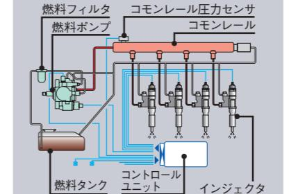
排出ガス3次規制に対応するため採用した新しいタイプの燃料噴射システムです。燃料ポンプを超高压で駆動し、気筒ごとのインジェクタに燃料を分配して噴射するシステムです。さらに、電子制御により1,000分の1秒単位で燃料の噴射タイミング、噴射量をきめ細かに制御。この結果、燃料噴射量の最適化が図れ、高出力化ならびに不完全燃焼によるPM(黒煙などの粒子状物質)低減や低燃費を実現します。
