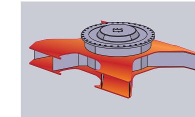
上下板には1枚板の曲げ構造を採用しました。溶接部を減らすことによって、Xビーム構造全体の信頼性が向上しました。
