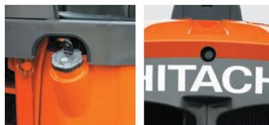
燃料給油口キャップやエンジンフードはいたずらなどによる事故を防止するため専用キーでロックできます。
