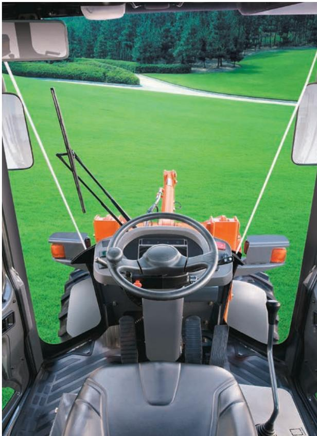
フロントには大型ガラス、左側ドアには大型スライドサッシを採用。広い作業視界を確保するため、従来機にはなかった下ガラスを追加し、リアコーナピラーの廃止と新形状のデフロスタノズルなどの改善を図った周囲を見わたせるパノラマキャブです。
