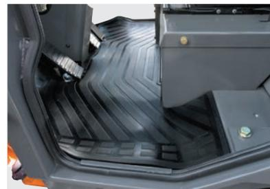
キャブはドア周辺のデザインを変更して段差のないフラットなフロアにしました。ほうきで掃くだけの手軽な作業で、キャブ内の掃除が可能です。
