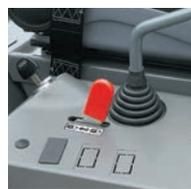
作業機の操作レバーをロックする安全機構です。オプションの 3 連用レバーにもレバーロックが装備されます。
