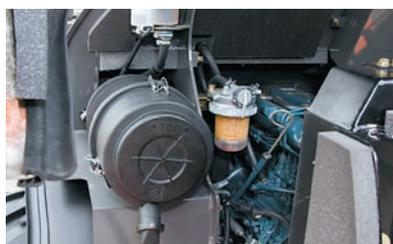
燃料および油圧系統のフィルタ類を点検・交換がしやすい位置にレイアウトしています。燃料フィルタはウォータセパレータ機能を併せもつ一体型。エンジンオイルフィルタ、作動油タンクリターンフィルタなどフィルタ類はすべてカートリッジ式で交換が容易です。
