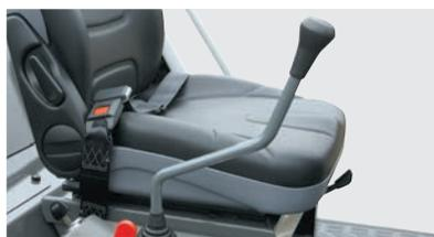
作業機をスムーズでスピーディにコントロールする、確実に扱いやすいフロント操作レバーです。
