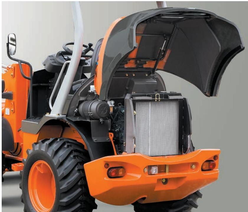
フルオープン的大型ボンネットとローウェストカウンタウエイトの採用により、日常のメンテナンスを簡素化しました。ボンネットはワンタッチで開き、ガスダンパで保持されます。大きく開放できるエンジンルームは点検、交換、補充などメンテナンスが無理のない姿勢で行えます。
