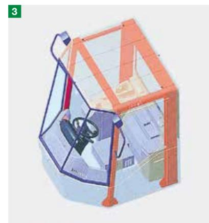
Rollover Protective Structure ROPS 転倒時運転者保護構造 Falling Object Protective Structure FOPS 落下物保護構造
