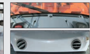
エアコン吹き出し口&デフロスタ
