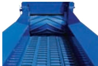
大型ホッパを採用した水平連続供給方式により長尺物の処理も効率良く行えます。
