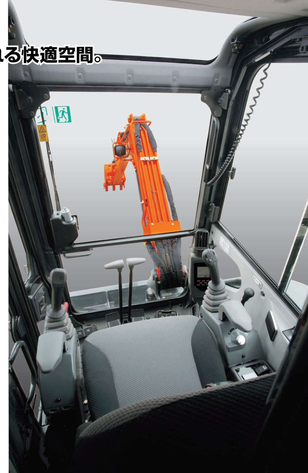
写真はキャブ仕様、オプション品（リフトレスト、マルチファンクションレバー、布シート、巻込み式シートベルト、フロントのホースプロテクタ）を含んでいます。
