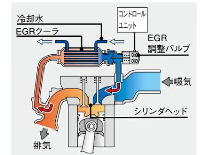
一度燃焼させた排出ガスの一部を吸入空気と混合し、再燃焼させる機構です。燃焼室内の酸素濃度を抑制することとEGRクーラにより燃焼温度を下げることで、高出力を確保しつつ大気汚染物質であるNOx(窒素酸化物)の排出低減と低燃費を実現します。
