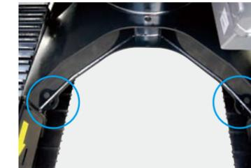
輸送時の機械固定用フック穴をトラックフレームの下フランジ部前後計4カ所に設けました。
