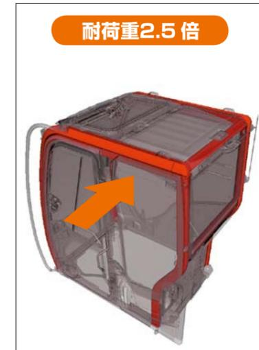
キャブの強度、剛性が大幅にアップした転倒時運転者保護構造を採用し、転倒に対する安全性を向上。この構造は、日本のJCMASが規定する安全基準（EOPS）に適合しています。例えば、キャブ上部に横方向の荷重を加えた場合、従来機ZAXISに比べ2.5倍の荷重に耐えることができます。
