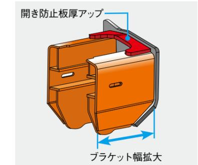
アイドラブラケット開き防止板厚を増加。外方向への開きを防止し、トラックリンクおよびローラ類などの足回り部品の耐久性が向上しました。
