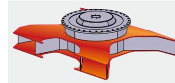
Xビーム構造のボックス寸法拡大や構造改良により、断面性能が最大で35%向上(対従来機ZAXIS)。さらに、上下板には1枚板の曲げ構造を採用しました。溶接部を減らすことで、Xビーム構造の強度および品質が向上しました。
