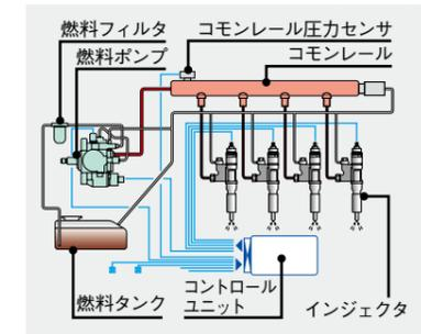
排出ガス3次規制に対応するため採用した新しいタイプの燃料噴射システムです。燃料ポンプを高圧で駆動し、気筒ごとのインジェクタに燃料を配分して噴射するシステムです。さらに、電子制御により1000分の1秒単位で燃料の噴射タイミング、噴射量をきめ細かに制御。この結果、燃料噴射量の最適化が図れ、高出力化ならびに不完全燃焼によるPM(黒煙などの粒子状物質)の低減や低燃費を実現します。
