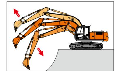
boom下げ時のフロントの重さを利用して、圧油をboom回路内で循環(再生)する機構。この結果、ポンプからの圧油を集中的にアームに供給することができ、アーム/boom下げ複合動作時のアーム動作のスピードアップが大幅に図られました。
