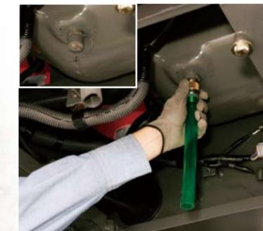
エンジンオイルパンにドレンカプラを装備。備え付けのノズルホースにより、容易にドレン作業が行えます。
