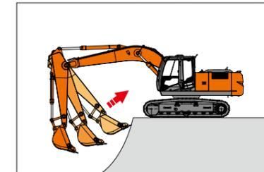
今まで、タンクに戻っていたboom戻りの圧油をアーム動作に再利用しました。この機構により、掘削時のアーム引き動作のスピードアップが大幅に図られました。
