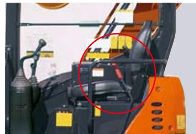
ロックレバーを上げると、フロント・旋回操作をロックします。不意のレバー操作による誤操作を防ぎます。
