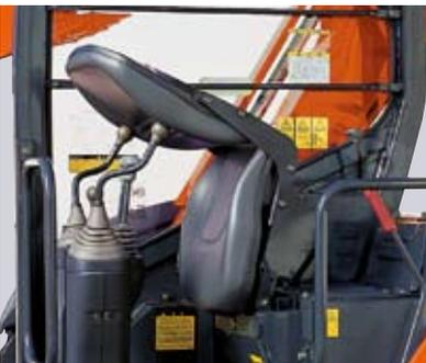
オペレータシートは、雨水などのしみ込まない表皮一体成形シートです。
