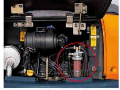
燃料ラインへの水分の混入を防ぐ、燃料フィルター一体型ウォーターセパレータ (水分離器) を標準装備しました。
