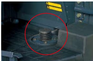
ペダル操作で走行スピードの切替えが可能。トラックへの積み込みや現場内移動もスムーズ&スピーディに行えます。
