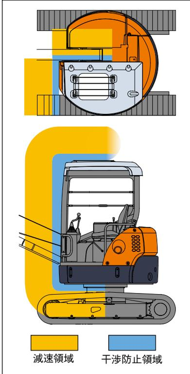
バケットが運転室に近づくときフロントスピードが減速。さらに近づくとき、フロントが自動停止してアラームで知らせます。
