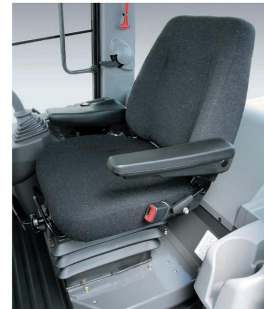
ボディから伝わる衝撃を受け止めるシートは、その性能がオペレータの肉体的なストレスに最も大きく影響します。そこで不快な振動を吸収するサスペンションシートを採用し、身体への負担を低減しつつ、快適性を確保しています。
