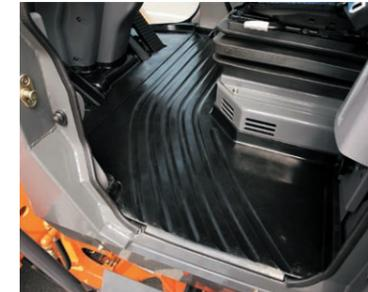
キャブドア周辺のデザインを変更し、段差のないフラットなフロアを実現。ほうきで掃くだけの手軽な作業で、キャブ内の掃除が可能です。
