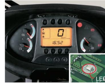
インジケータや警告表示、液晶モニタのバックライトなどに、LED（発光ダイオード）を採用。従来の電球や蛍光管と比べて長寿命で、球切れなどのトラブルが起こりにくいため、表示系の信頼性が大きく向上しています。
