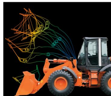
新パラレルタンデム回路の導入により、従来機ではできなかったリフトアームとバケットを同時に動かす複合動作が可能になりました。掘削や積み込みといったフロント作業を効率良く、スムーズに行えます。
