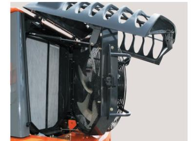
温度感応型油圧駆動の冷却ファンは、清掃時などに逆回転させることが可能。これにより、手軽な操作でラジエータに詰まったごみなどを取り除くことが可能です。また、油圧駆動ファン自体も、ヒンジによって開閉が可能ですので、エアブローによる清掃作業も行えます。
