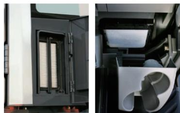
外気フィルタは、キャブ外側から簡単に交換できます。また、内気フィルタもキャブ内のドリンクホルダ部を外すだけで簡単に交換できます。
