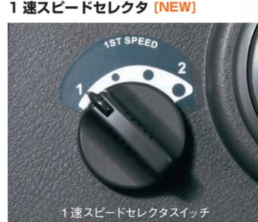
1速の最高速を作業内容に応じて4段階に選択可能。積み作業などで現場の広さに応じた車速を選択することにより、微妙なアクセルやブレーキ操作を軽減できます。
