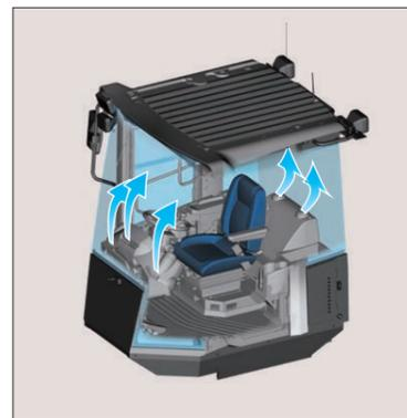
フロント3ヵ所、フロントサイド2ヵ所、リア2ヵ所のデフロスタを標準で装備。雨天時や寒冷時に発生しやすいガラスの曇りを除去し、視界を良好に保ちます。
