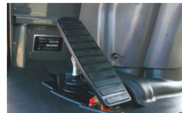
ブレーキ/インテグペダルはアクセル操作とは無関係に車速に相当する走行用油圧ポンプの吐出量を調整します。この結果、ブレーキ/インテグペダルだけで車速の調整が可能です。積み込みの際の位置合わせを容易に行えます。
