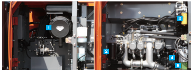
1 エアクリーナ 2 エンジンオイルフィルタ 3 パイロットフィルタ 4 燃料プレフィルタ 5 燃料メインフィルタ
